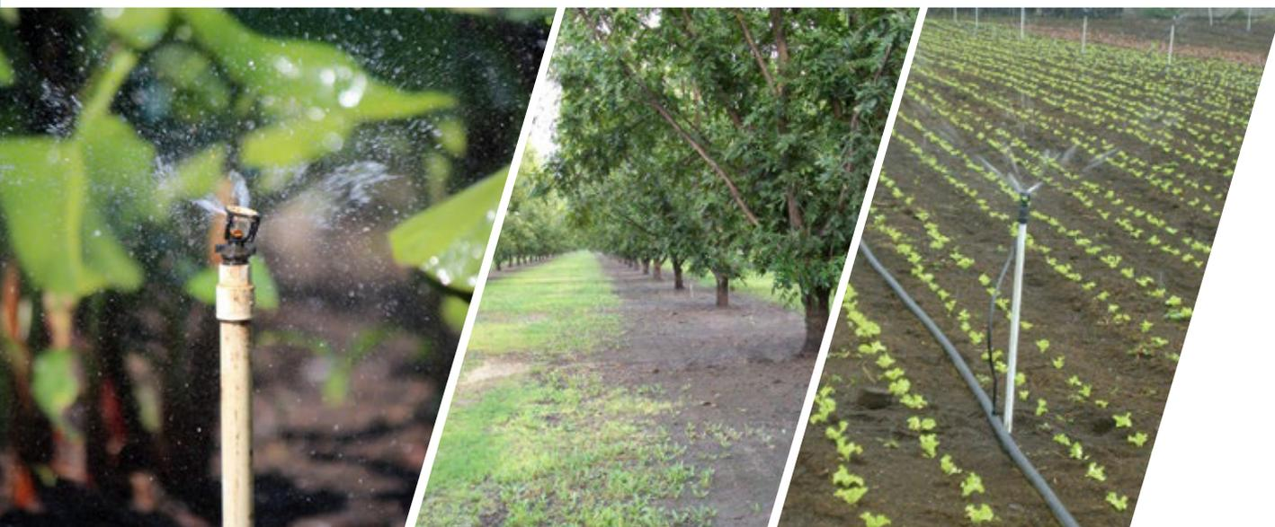
O aspersor **Mini Wobbler** opera através da rotação de um defletor ranhurado combinada com uma ação oscilante. Os aspersores **Mini Wobbler** distribuem as gotas de chuva, com menor intensidade de aplicação sobre uma maior área de cobertura a baixas pressões. Estas características ajudam a reduzir a compactação do solo e o escoamento superficial.
